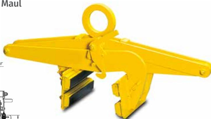
Blockgreifer sind für alle parallelwandigen Güter verwendbar, die dem Anpressdruck der Greifbacken standhalten, der doppelt so groß wie das aufgenommene Gewicht ist. Die Geräte werden serienmäßig mit auswechselbaren Hartgummi-Profilleisten geliefert.
